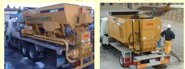
パークブロワ機による破碎チップ利用
