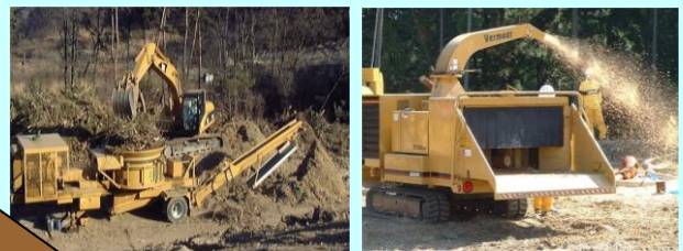
各種破碎機にてチップ化して利用
